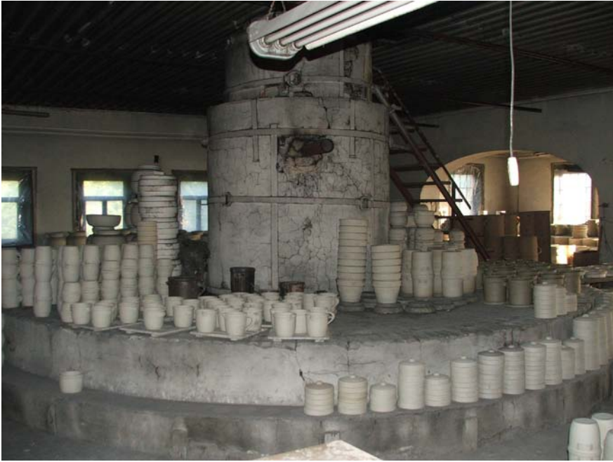
Fig. 12. Parowa – dawna manufaktura porcelany (1), obecnie wytwórnia kamionki – górna część pieca „muflon”
