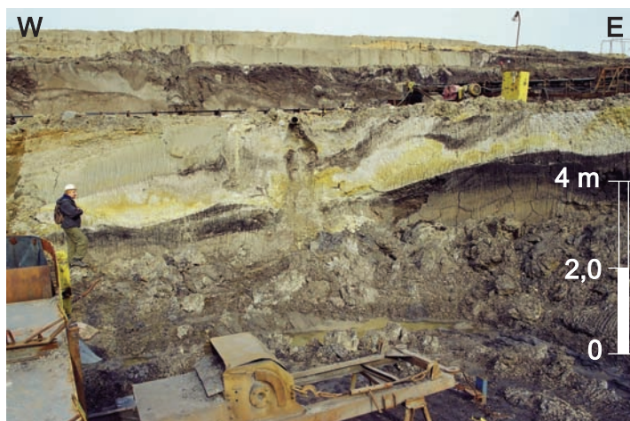
Fig. 7. Wielokrotne nasunięcia i złuski w stropowych partiach osadów neogenu (iły, iły zawęglone) związane ze starszym etapem deformacji glaciektonicznych. Skarpa północnego zbocza odkrywki „Stanisław – Północ” pomiędzy poziomami +162m and +166m.
