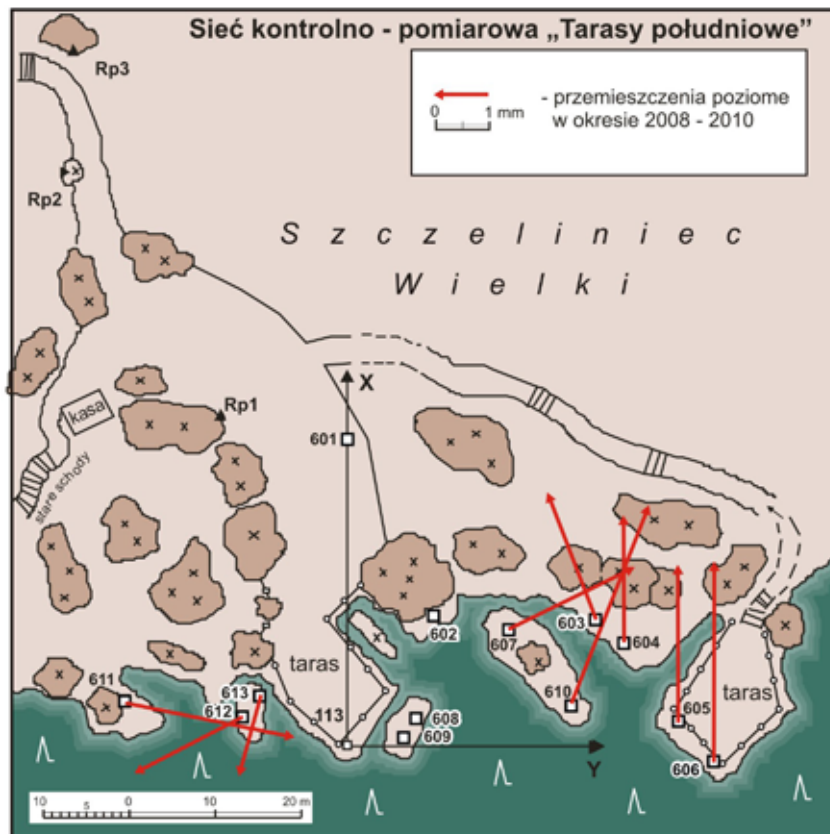
Ryc. 7. Rezultaty przemieszczeń poziomych punktów na tarasach południowych
